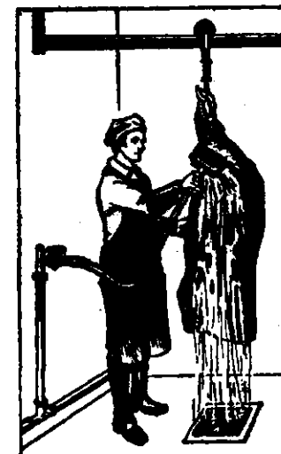
Рис. 11. Мойка мяса при помощи щетки-души
